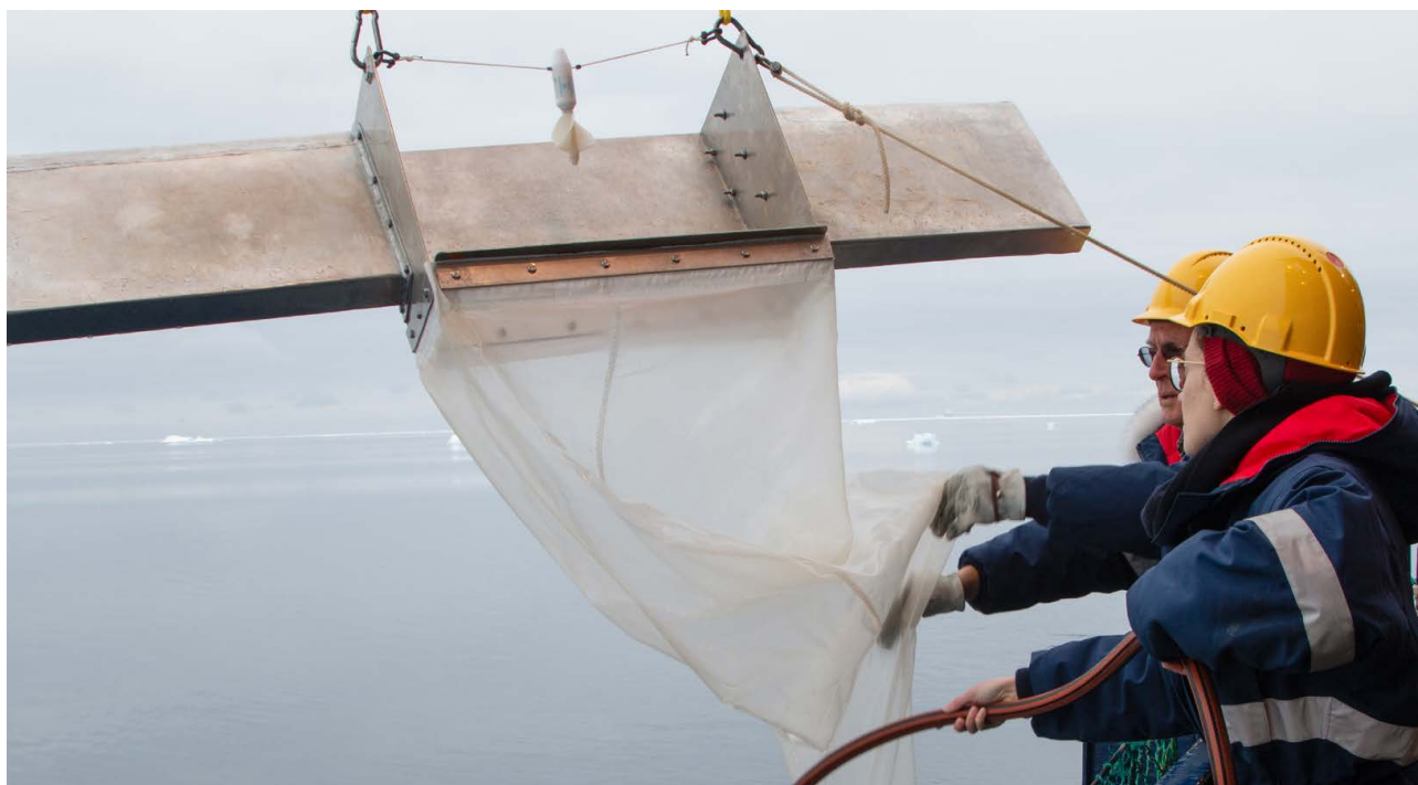
Rete da plancton per il campionamento della superficie dell'acqua in uno studio sulle microplastiche nell'Antartide.
